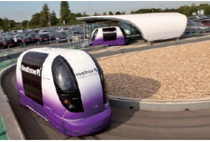
自動運転車の一例 ヒースロー空港(英)のPod(ポッド)専用レーンを走行する4人乗りの自動運転車
